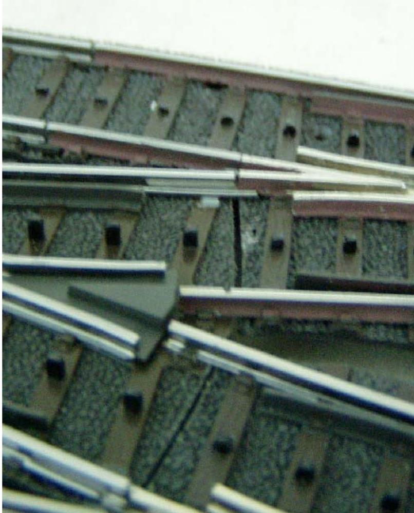
Ist der schlanke C-Gleishosenträger soweit fertig, kann man mit einem Wagen schon mal erste Rollversuche machen, bevor man ihn verklebt und dann nur noch schwer etwas ändern kann. Diese Rollversuche haben bei mir an beiden bis jetzt gefertigten Hosenträgern auf Antrieb funktioniert.
