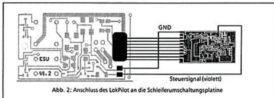
Abb. 2: Anschluss des LokPilot an die Schleiferumschaltungsplatine
